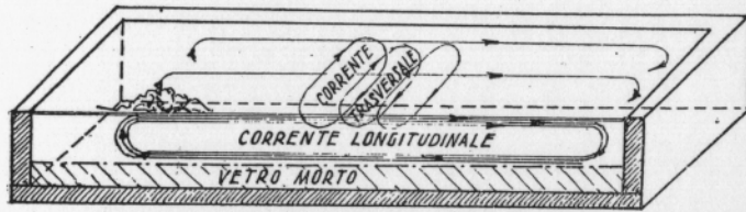
Fig. 31 — Rappresentazione schematica delle correnti nei bacini a lavorazione continua.
